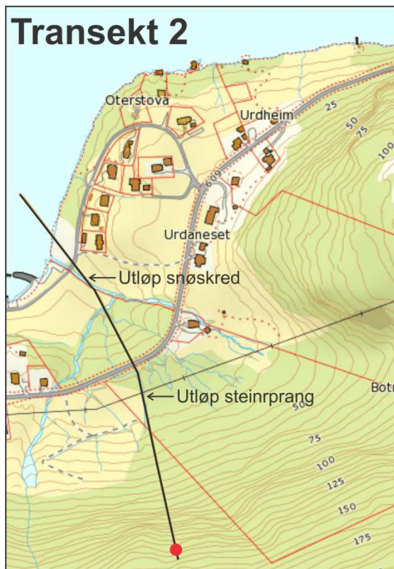
Figur 15: H/L-forholdet for steinsprang og snøskred langs dei to transekta ved Urdaneset. Generelt kan ein sei at den potensielle utløpsdistansen vert noko lenger for begge skredtypane. Spesielt snøskred langs transekt to har ein tydeleg lenger modellert utløp med denne metoden i forhold til alpha-beta-metoden. Basert på kart frå Statens kartverk.
