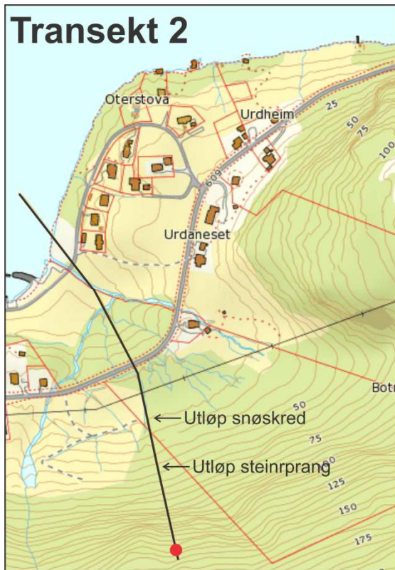
Figur 13: Alpha-beta-metoden nytta på to transekt (svarte linjer) ved Urdaneset for å rekne ut potensiell utløpsdistanse for steinsprang og snøskred. Ein ser at utløpsdistanse for steinsprang ikkje når ned til undersøkingssområdet langs nokon av transekta. Utløpsdistanse for snøskred er noko lenger, men heller ikkje her er undersøkingssområdet innanfor det som er modellert som risikoområde. Basert på kart frå Statens kartverk.
